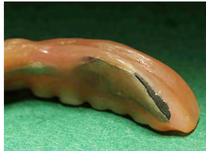
Nach Abplatzen des Kunststoffes lag die alte Bleibeschwerniss-Einlage frei. Es kam jetzt zu einem Galvanischen Element, Korrosion zwischen den Legierungen im OK und der Bleieinlage. (Batteriewirkung)
